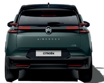
Rozchod zadních kol MHEV 1622 mm • PHEV 1632 mm • BEV 1636 mm
