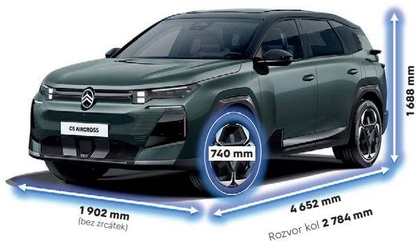
Rozchod předních kol MHEV 1620 mm • PHEV 1630 mm • BEV 1630 mm
